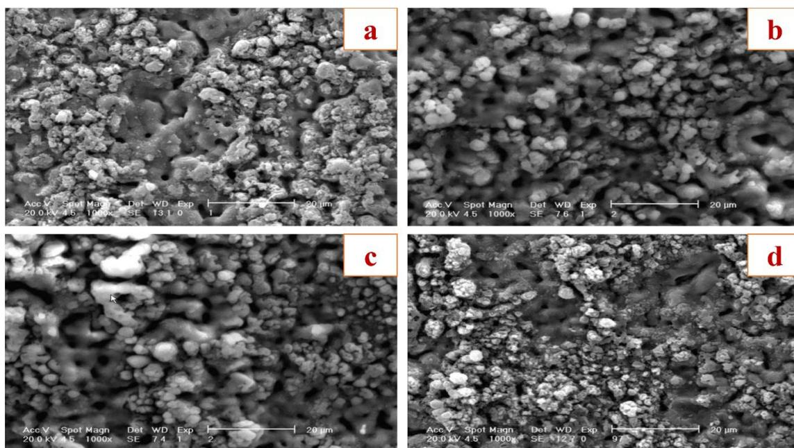
Fig. 2. SEM image of coating surface ( $\times 1000$ ) (a) A-15-13 (b) A-15-26 (c) A-15-40 (d) P-15
