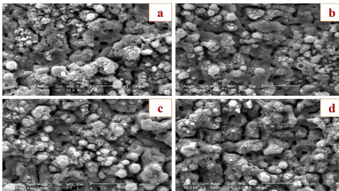
Fig. 3. SEM image of coating surface ( $\times 1000$ ) (a) A-25-13 (b) A-25-26 (c) A-25-40 (d) P-25
